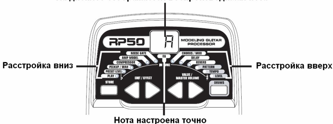
В режиме тюнера возможна смена опорного тона. Заводская установка  $A = 440$  Гц (отображается в виде 40). Вращением **Регулятора 1** можно сменить настройку:  $A = A\flat$  (отображается в виде  $A\flat$ ),  $A = G$  (отображается в виде 9) и  $A = G\flat$  (отображается в виде  $9\flat$ ). Новая настройка будет быстро мигать на дисплее. Чтобы выйти из тюнера нажмите на любой из переключателей. Настройки опорного тона сохраняются после выключения процессора.
