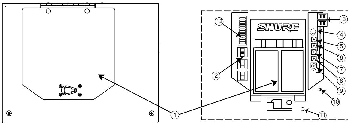
1. Отсек для батареи: устанавливаются две щелочные батареи напряжением 9 В. Они обеспечивают работу устройства в течении 8 часов.
