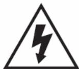
Символ молнии в равностороннем треугольнике означает «электрическая опасность». Он обозначает наличие информации о рабочем напряжении и потенциальном риске электрического удара.
