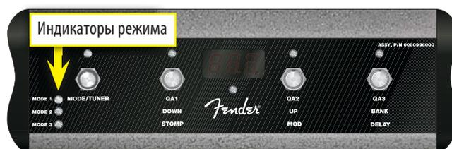
Ножной переключатель предусматривает три режима работы, которые обозначаются с помощью индикаторов MODE 1, MODE 2 и MODE 3. Кроме того, имеется также режим настройки Tuner (горят все три индикатора).
