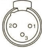
Выход DMX Разъем XLR (вид сзади)
