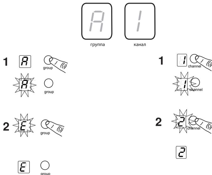
При подключении дополнительных систем оставьте первый передатчик и приемник включенными. Настройте все подключаемые дополнительно приемники на ту же группу, что и первый приемник. **ЗАМЕЧАНИЕ:** после выбора группы приемник автоматически сканирует каналы и настраивается на доступную частоту. Настройте передатчик на частоту, используемую приемником.
