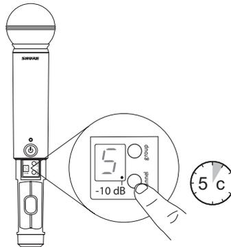
1. Для выбора значения чувствительности -10 дБ, держите нажатой кнопку 'channel' до тех пор, пока в нижнем правом углу дисплея передатчика не появится символ "." (точка).
