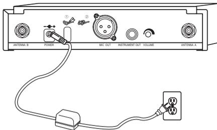
2. Подключите приемник к микшеру или усилителю. Включите приемник, нажав на кнопку питания.
