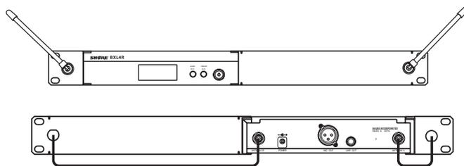
Схема подключения антенн
