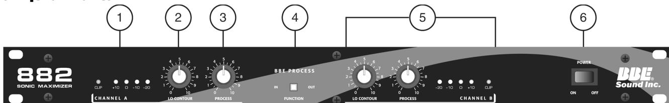
1. Светодиодный дисплей: Отображает уровень сигнала BBE 882 в соответствии с нанесенными на панель числовыми значениями в децибелах. Светодиод "Clip" загорается при достижении входным сигналом уровня +20 dBu, предупреждая о возможности перегрузки при входном сигнале +23 dBu.
