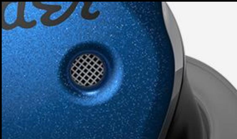
*Басовый порт Groovetuned™ на моделях FXA2-FXA9. Воспроизведение басовых частот требует большего объема воздуха, Конструкция басового порта позволяет большему количеству воздуха достигать драйвера без увеличения объема корпуса и веса монитора.*
