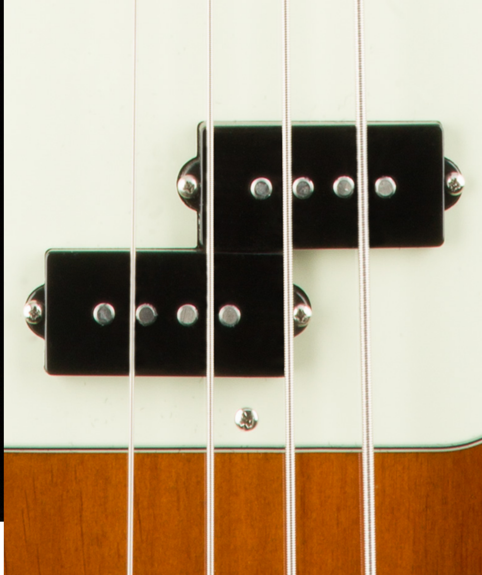
ЗВУКОСНИМАТЕЛИ: V-MOD SPLIT SINGLE-COIL PICKUP
