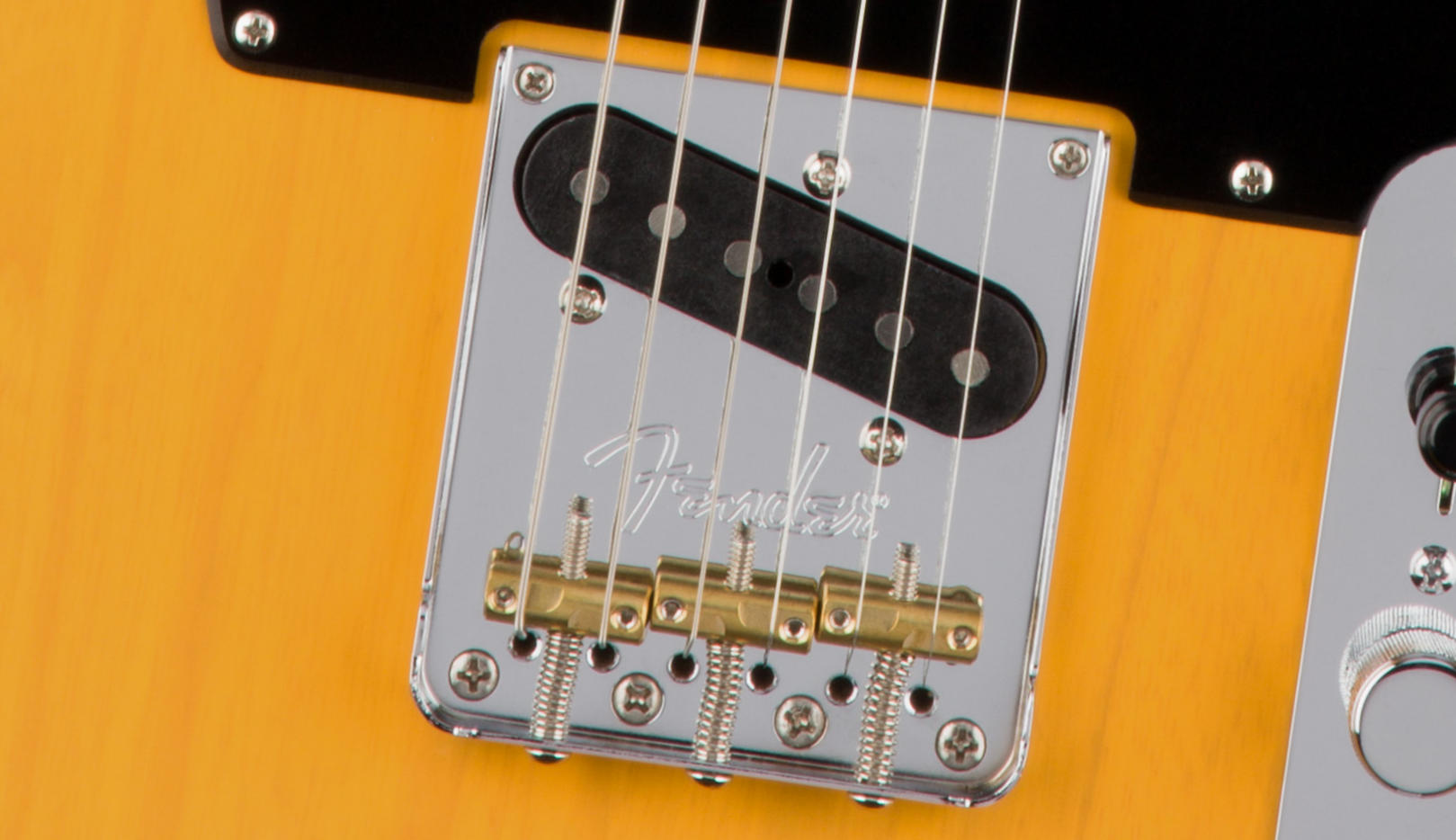
БРИДЖ: 3 СЕДЛА, КОНСТРУКЦИЯ «СТРУНЫ СКВОЗЬ КОРПУС», КОМПЕНСАЦИЯ ПОЛОЖЕНИЯ СЕДЛА ПО ВЫСОТЕ, КРЕПЛЕНИЕ НА 6-ТИ ВИНТАХ, СНИМАЮЩАЯСЯ СОВРЕМЕННАЯ «КРЫШКА ПЕПЕЛЬНИЦЫ».
