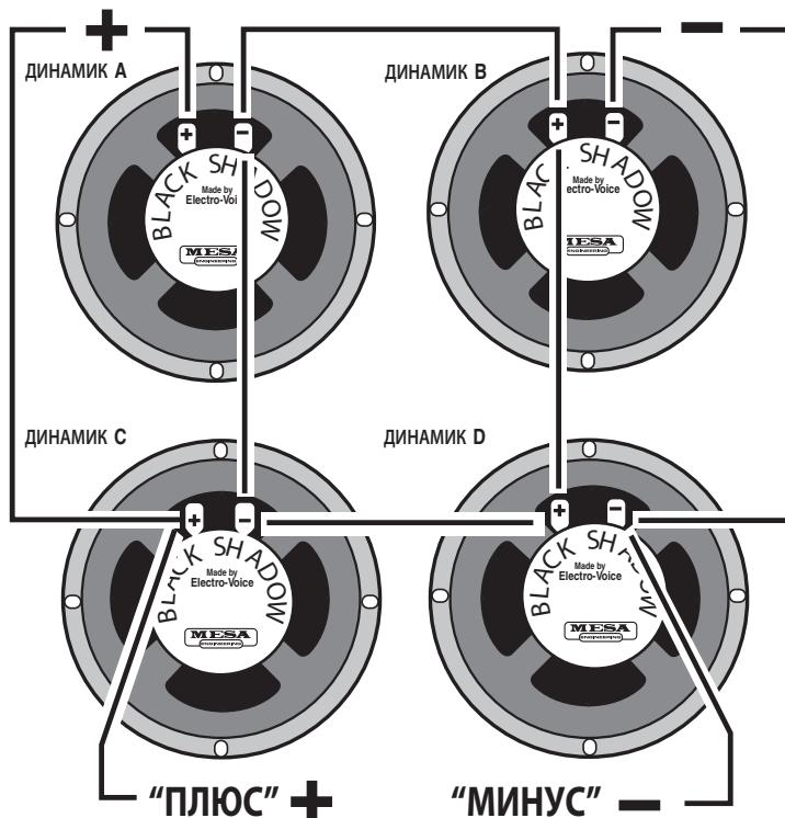
В данном случае два набора динамиков, подключенных последовательно, подключаются параллельно. Таким образом можно соблюсти согласование нагрузки при подключении нескольких динамиков. Важность данной схемы подключения очевидна в случае, если необходимо подключить к усилителю более одного кабинета. Именно в данной ситуации первостепенное значение имеет умение рассчитывать итоговую нагрузку и не допустить подключения к усилителю нагрузки со слишком малым сопротивлением.
