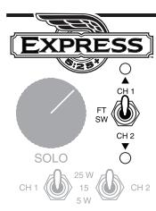
Данный трехпозиционный тумблер служит для ручного выбора каналов, если ножной переключатель к усилителю не подключен. В положении CH 1 (верхнем) активен канал 1, и горит светодиод зеленого цвета; в положении CH 2 (нижнем), активен канал 2, и загорается светодиод красного цвета.
