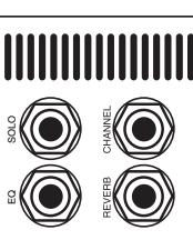
Четыре разъема 6.3 мм, подписанные SOLO, CHANNEL, EQ и REVERB, предназначены для случая, если требуется управлять Express Plus с помощью внешнего мастер-переключателя. Они позволяют загружать звуки Express Plus без использования ножного переключателя, а также назначить управлять эффектами с помощью специализированного MIDI-контроллера.
