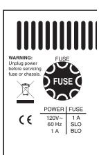
Гнездо для главного предохранителя, служащего для защиты усилителя в случае перегорания лампы или скачка напряжения в сети. Всегда заменяйте предохранитель только на полностью аналогичный, в противном случае усилитель может выйти из строя. Использование предохранителя некорректного типа не только приводит к риску выхода усилителя из строя, но и аннулирует гарантию. Обе модели усилителей Express Plus используют предохранители типа Slo-Blo (с медленным сгоранием).
