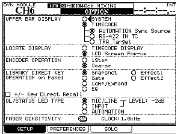
Рисунок 2.38 Экран опций SETUP UPPER BAR DISPLAY.
