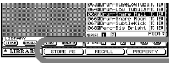
Рисунок 2.6 Клавиши POD со 2 по 4 используются как программные клавиши.
