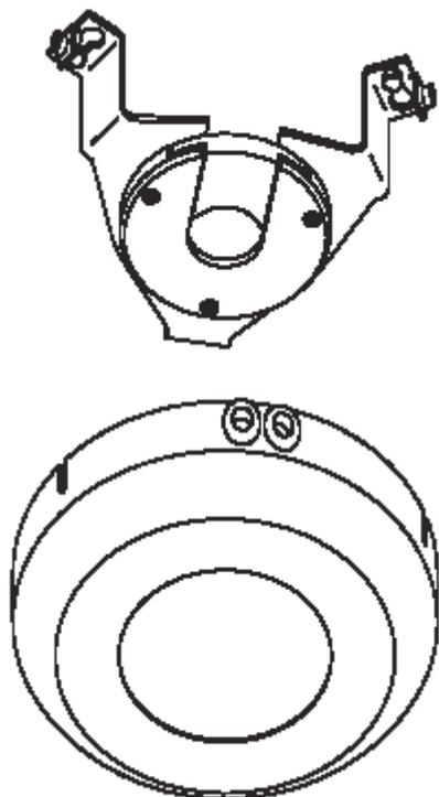
3. С помощью 3 мм ключа открутите два блокирующих винта, удалите вложенную часть J-Box.
