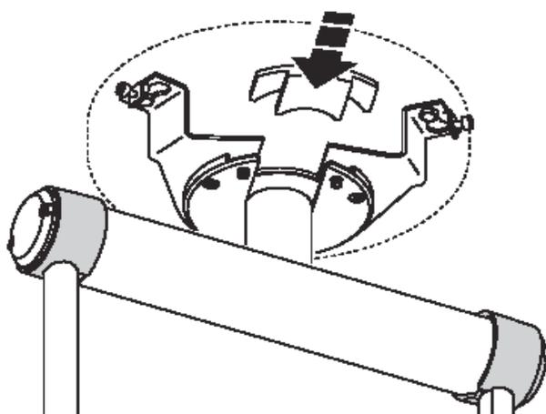
5. Передвиньте Alien 02 Pendant на правильную позицию панорамирования и закрутите два винта блокировки панорамирования с помощью 3 мм гаечного ключа. Закрутите три винта на кронштейне J-Box.
