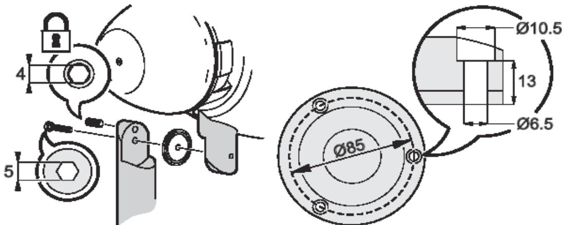
2. Установите основание кронштейна на требуемую поверхность с помощью монтажного оборудования М6, соответствующего монтажной поверхности и весу прибора.
