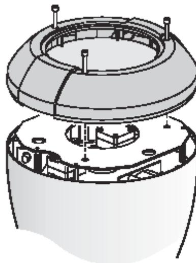
разделе). Установите на место металлические пластины и винты, удерживающие линзу на месте.
