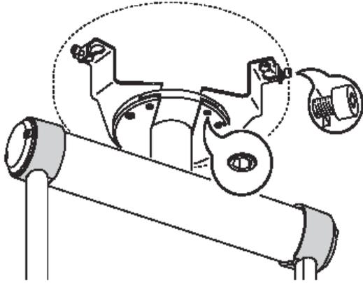
6. Подключите кабели на Alien 02 к кабелям, подключенным к 150W Base. Кабели могут быть пропущены либо через потолочное пространство через J-Box, либо через два отверстия в крышке J-Box (сделайте разрез в каждой из резиновых прокладок и пропустите кабели в отверстие через них).
