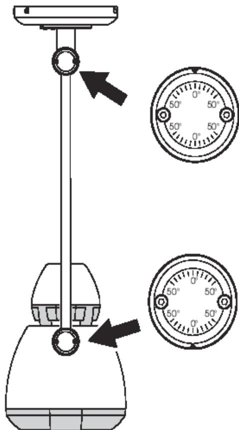
Регулировка угла поддерживающего кронштейна или лампы выполняется с помощью регулировки в шарнирах в двух местах. Для регулировки шарнира, используйте 3 мм гаечный ключ. Открутите шарнир на любой из сторон прибора. Отрегулируйте на нужный угол - +/- 50 градусов и затяните вновь.
