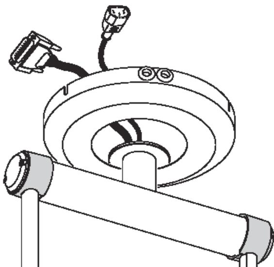
4. Задвиньте фланец в слот J-Box. Установите на место извлеченную секцию (обратите внимание, что в круге показан разрез крышки J-Box).
