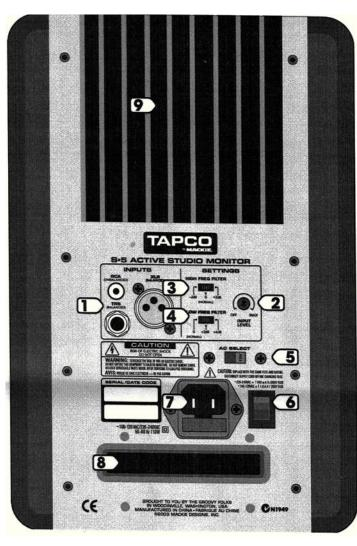
Переключатель HIGH FREQ подстраивает общую высокочастотную характеристику на + 2 дБ на 5 кГц и выше. Оставьте этот переключатель в позиции «0» (NORMAL), если:
