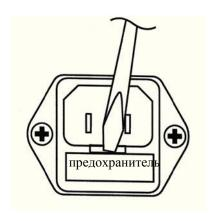
3. Удалите предохранитель и замените его на предохранитель эквивалентного типа.
