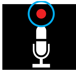
Индикатор фантомного питания 48 В на дисплее Duet
