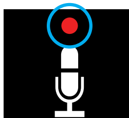
Индикатор фантомного питания 48 В на дисплее Duet
