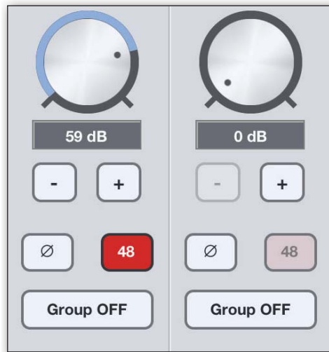
Индикатор фантомного питания 48 В на дисплее Duet
