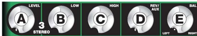
**A. LEVEL (громкость)** - регулирует уровень громкости отдельного канала. Поворот ручки по часовой стрелке увеличивает громкость сигнала соответствующего канала в микс основного выхода «Main Out», поворот против часовой стрелки уменьшает громкость. Отрегулируйте этот регулятор после того, как был установлен мастер-уровень громкости выхода Passport.
