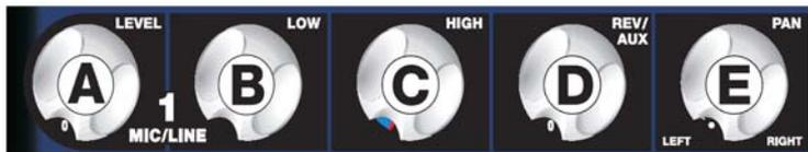
**A. LEVEL (громкость)** - регулирует уровень громкости отдельного канала. Поворот ручки по часовой стрелке увеличивает громкость сигнала соответствующего канала в микс основного выхода «Main Out», поворот против часовой стрелки уменьшает громкость. Отрегулируйте этот регулятор после того, как был установлен мастер-уровень громкости выхода Passport.
