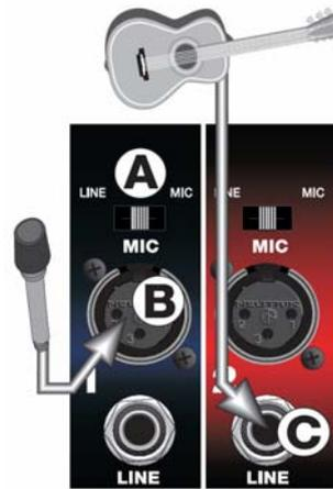
**A. Переключатель LINE / MIC** - этот переключатель позволяет Вам выбрать уровень усиления для микрофона, либо для сигнала линейного источника. Когда переключатель установлен в линейном положении, входной уровень оптимизирован для таких элементов как гитара, драм-машины, клавиши, внешние эффекты и т.п.
