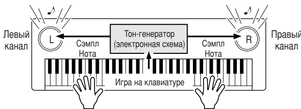
Играя на клавиатуре, вы посылаете команду воспроизвести ту или иную ноту через динамики электронного инструмента. Все ноты хранятся в виде сэмплов в тон-генераторе.
