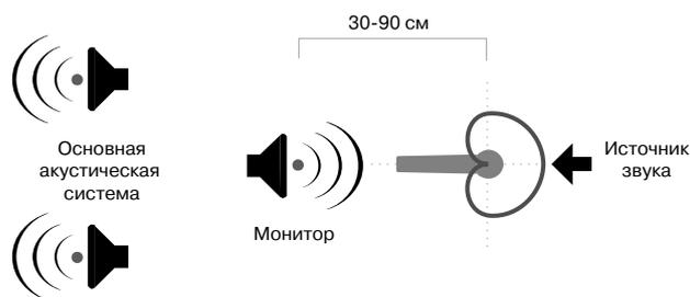
2. Располагайте микрофон на максимальном расстоянии от отражающих поверхностей и акустических колонок.
