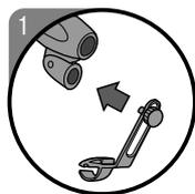
1. Совместите крепежный винт держателя с соответствующим ему резьбовым отверстием микрофона PG56.
