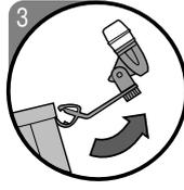
3. С помощью зажима держателя закрепите микрофон на внешней кромке обода барабана и установите его в нужном положении.
