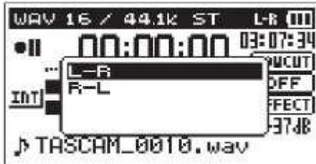
4 Используйте кнопку + или -, чтобы выбрать (выделить) L - R или RL в зависимости от состояния микрофона пары.
