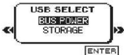
Используйте кнопку + или -, чтобы выбрать ХРАНИЛИЩЕ, и нажмите на кнопку ENTER / MARK кнопки для подключения устройства к компьютеру для передачи данных. В сообщении USB связанной появится на дисплее.
