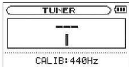
TUNER экран содержит CALIB возможность установить основную частоту А. Нажмите кнопку N или кнопку, чтобы уменьшить или увеличить основной частоты. Диапазон настройки: 435Hz – 445Hz (в с шагом 1 Гц, по умолчанию:
