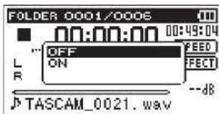
4 Используйте кнопки + или – для выбора ON, а затем нажмите ENTER / MARK кнопку, чтобы включить функцию выравнивания уровня. Или выберите OFF и нажмите на кнопку ENTER / MARK кнопку, чтобы выключить функцию выравнивания уровня.
