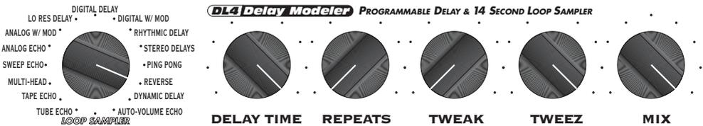
Ручка “Tweak” регулирует скорость модуляции. \_\_\_\_\_
