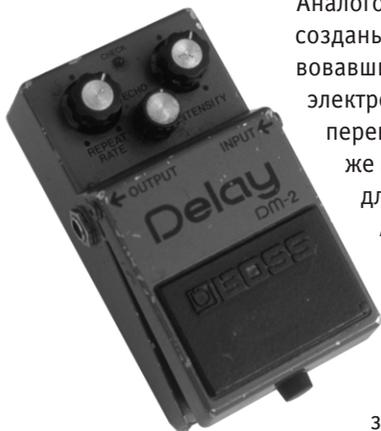
Аналоговые устройства задержки, такие как DM-2, были созданы как более совершенные по сравнению с предшествовавшими им ленточными задержками; в них применялась электронная схема, основанная на использовании эффекта переноса зарядов, что делало их более надежными, а также позволяло снизить потребляемый ток и использовать для питания батарейки.
