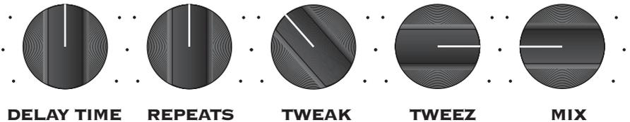
Ручка “Tweak” регулирует скорость модуляции.
