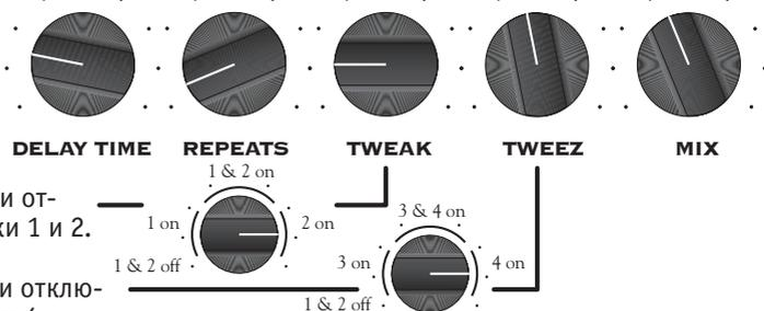
**Ручка “Tweak”** включает и отключает магнитные головки 1 и 2.
