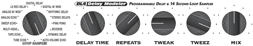
Ручка “Tweak” регулирует глубину модуляции.
