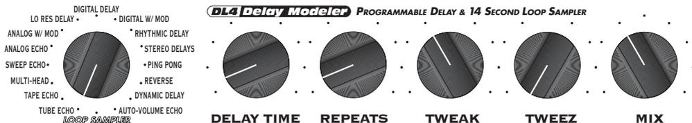
Ручка "Tweak" регулирует замедление и вибрацию эмулируемого лентопротяжного механизма.
