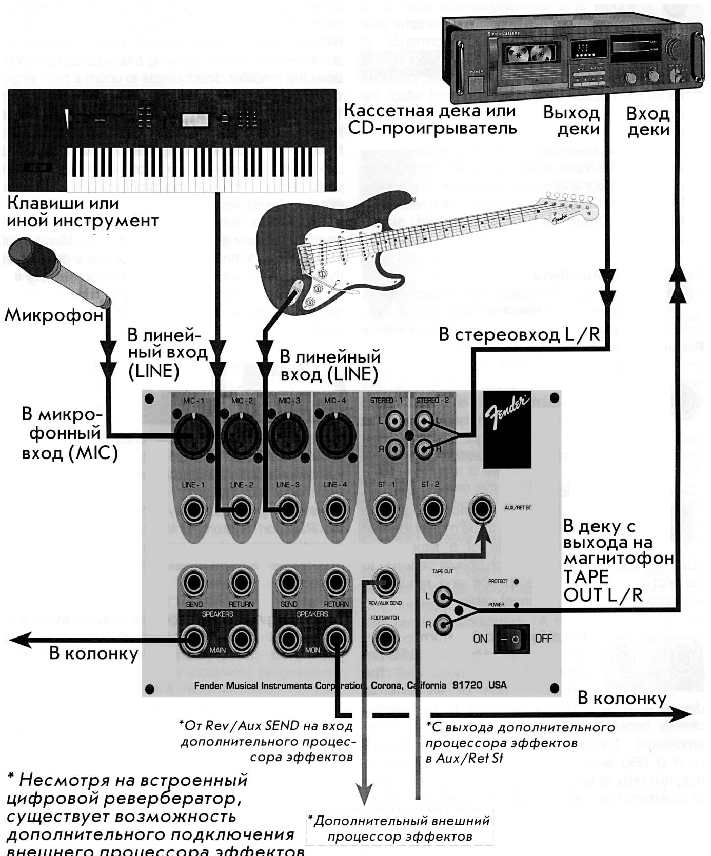
\* Несмотря на встроенный цифровой ревербератор, существует возможность дополнительного подключения внешнего процессора эффектов
