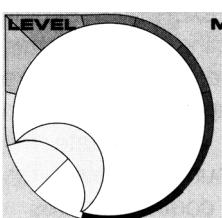
**Level** (уровень): Ручкой Level регулируют уровень входного сигнала, посылаемого на остальные этапы микширования. Правильная настройка этого регулятора имеет решающее значение для чистой неискаженной работы системы Passport.
