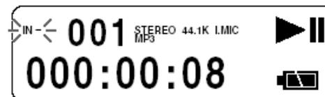
3. Продолжите воспроизведение PMD660 до нужной точки Out (Выхода), или используйте стандартные регуляторы перехода, такие как кнопки **▶▶** или **▶▶▶** для захвата больших временных промежутков.
