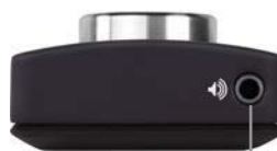
Сtereo выход на наушники Выход на динамики
