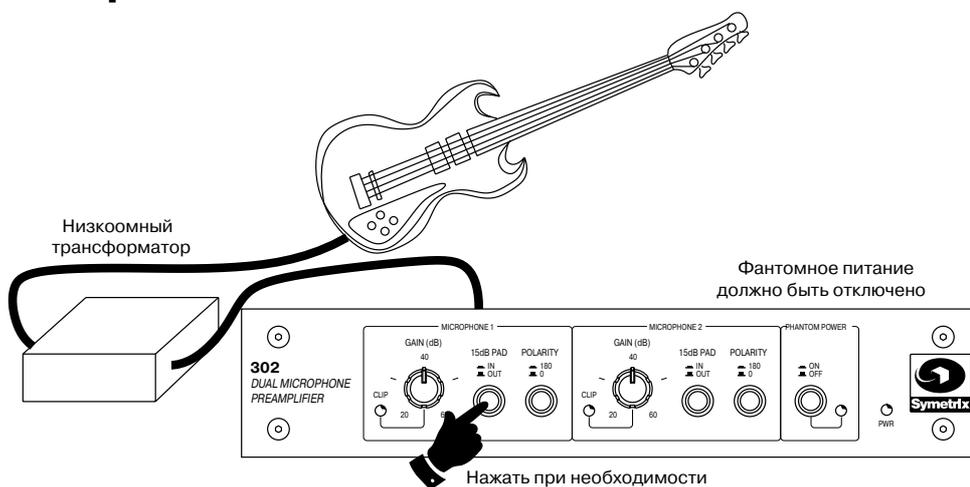
Типовой выходной уровень гитарных звукоснимателей находится посередине между микрофонным и линейным уровнями. Выходы звукоснимателей гитар (не усилителя!) может подключаться ко входу 302 без перегрузки через *низкоомный трансформатор с коэффициентом передачи 1:1*. Никогда не подключайте гитары непосредственно к микрофонному входу 302. Разделительный трансформатор защищает схему гитары от фантомного питания, а также предохраняет фантомное питание 302 от короткого замыкания.
