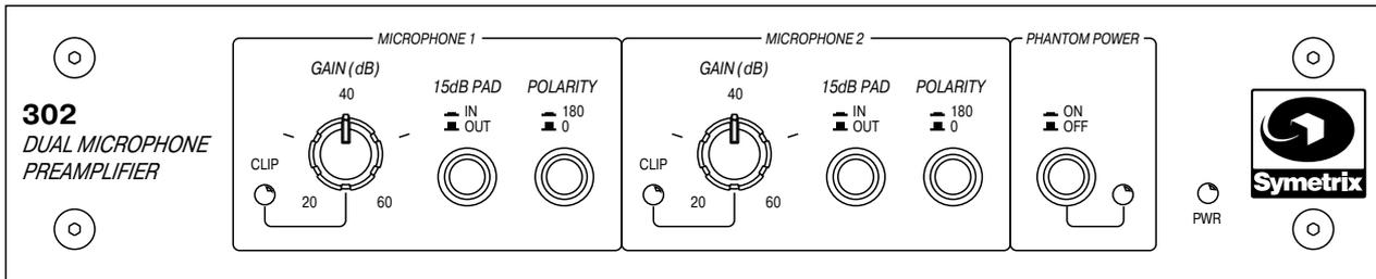
**Светодиод CLIP** - индикатор перегрузки, загорающийся по достижении сигналом уровня, на 3 дБ ниже максимального. Данный индикатор может периодически вспыхивать на пиках сигнала, но не гореть постоянно.
