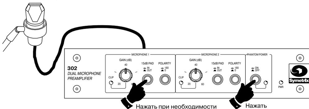
При использовании таких типов микрофонов, требующих фантомного питания, с Symetrix 302, используйте следующие установки:
