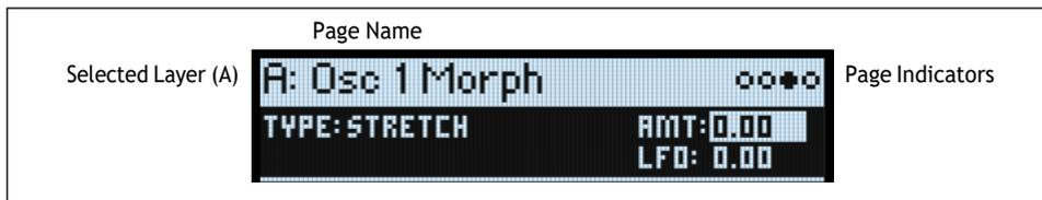
**LAYER A/B:** Слои (Layer) содержат программу, арпеджиатор и несколько других настроек. На передней панели одновременно редактируется один слой, выбранный этими кнопками. Чтобы включить или выключить слой, удерживайте **SHIFT** и нажмите кнопку слоя или просто дважды нажмите кнопку.
