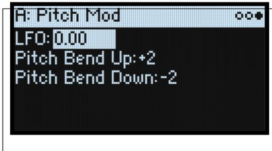
Эти настройки применяются ко всей программе, включая Osc 1/2 и саб-генератор. Чтобы модулировать высоту отдельных осцилляторов, используйте вместо этого страницу Osc Pitch.
