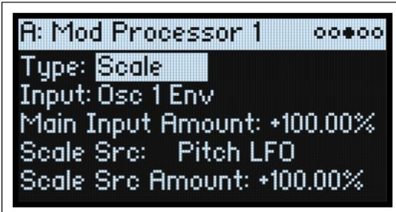
Этот процессор использует источник модуляции для масштабирования входного сигнала. Например, вы можете контролировать громкость LFO с помощью Envelope или контролировать громкость Envelope с помощью MIDI-контроллера.
